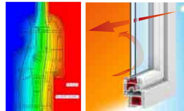
Bei mb-Fenstersystemen haben Sie eine deutliche Trennung von Wärme- und Kältezonon. Die Wärme wird im Haus gehalten, die Kälte bleibt ausgesperrt (siehe Beispiel Isothermenverlauf System energeto® Abb. links).
